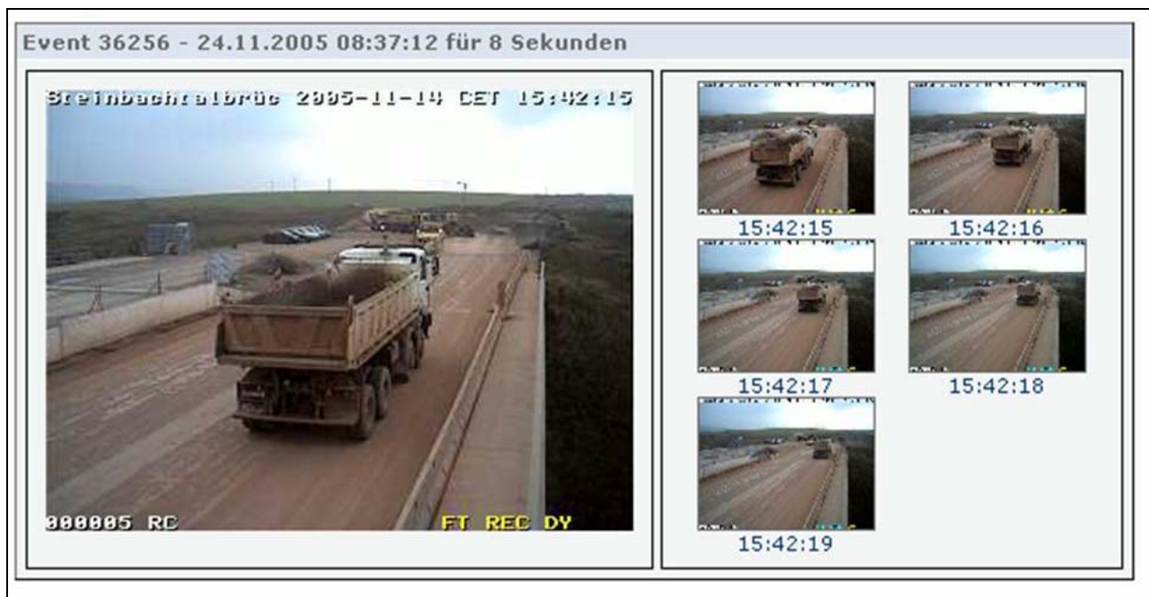
Fig. 3. Bilder zur Beweissicherung auf Grund der dynamischen Erkennung von LKW an der Fugenkonstruktion (Website)
