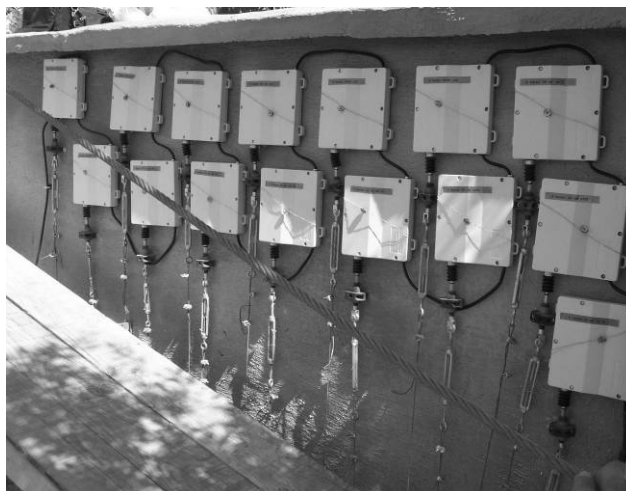
Abb. 4: X-Trigger "Zentrale" Kopf des Hanges, alle X-Trigger sind mit optischen Kabeln verbunden, die ein Auslösen der Sensoren sofort weiterleiten..
